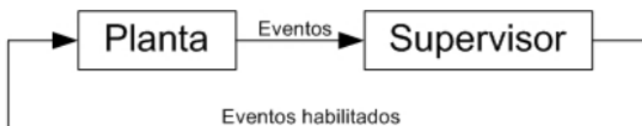
Figura 15 – Arquitetura do controle monolítico. Fonte: ( Ramadge, P.J.G.; Wonham, W.M., 1989 )
