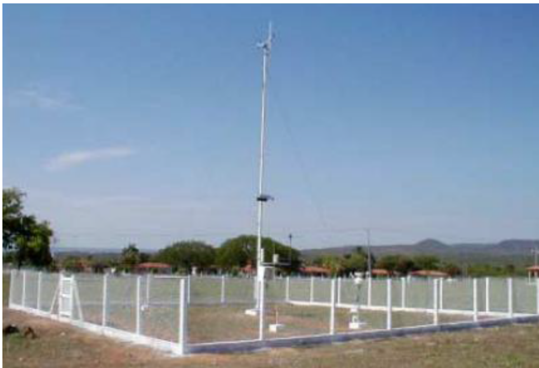
Figura 16 – típica Estação Meteorológica Automática composta por sensores, mastro com caixa data-logger, painel solar, pára-raios, cercado. Fonte: (INMET, 2011)
